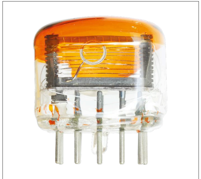
Figuur 1. Hier zijn de 'gestapelde' kathodes van een Nixie-buis duidelijk te zien.
